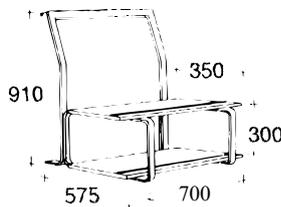
Projektorgestell mit 2 St. Platten aus Buche. Erhöhte Vorderkante an der oberen Platte. Hängebeschläge aus formgebogenem schichtgeleimtem Holz aus Buche.
