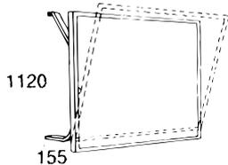
Projektions-Leinwand, gespannt auf Rahmen. Doppelschichtiges Gewebe. Stufenlos, nach vorn kippbar für OH-Projektion. Rahmen aus profiliertem Buche. Hängebeschläge aus formgebogenem schichtgeleimtem Holz aus Buche.
