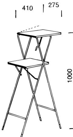
Projektortisch. Gestell aus schwarzlackiertem Stahlrohr mit schwarzlackierten Platten. Zum Ausgleich von Niveauunterschieden: ein Bein verstellbar.
