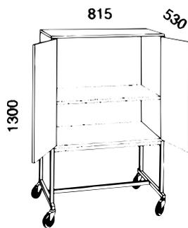
TV-Videoschrank, Gestell aus 25x25 mm Vierkantröhr. Versehen mit 4 Lenkrollen 100 mm, davon 2 blockierbar. Platten 19 mm in Buchenmuster. Abschließbarer Schrank mit 1 Einlegeboden, der in drei unterschiedlichen Höhen verstellbar ist. Innenmaße 495x760x810 mm.
