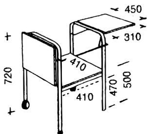
Overheadtisch, Gestell aus lackiertem ovalem Stahlrohr. Hochklappbare Seitenplatten. Projektorplatte platzierbar in zwei Höhen für verschiedene Projektoren. Mit 2 Doppelrollen 50 mm und einem einstellbaren Fuß.
