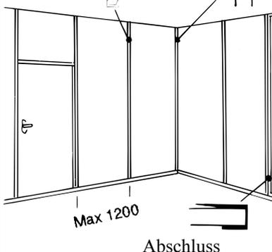
Pentagon Wände, Emailleschreibfläche laminiert auf 10mm Leichtgewichtsplatte oder 13 mm Gipsplatte. Breite 1200 mm. Kann auf vorhandene Wände montiert werden und bringt dann mehrere Funktionen, z.B. Schreibtäfel, Pinnwand
