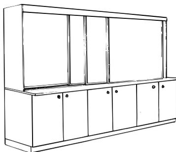
Schreibtäfel mit emaillierter Stahloberfläche, verschiebbare Einheiten und Unterschrank wie oben, sowie Unterschrank wie vorher beschrieben. Die feste Täfel kann an die Wand mit Distanzrahmen montiert werden.
