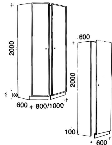
Schrank wie oben, aber mit montiertem Sockel an den Türen. 1 fester Einlegeboden 1450mm über dem Fußboden. Für Rolltisch mit Overhead- und Dia-Projektor oder anderes technisches Zubehör. 2 Türen.
