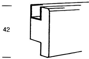
Tragleiste aus Buche. Oberkante mit eingefrästem U-Profil aus Aluminium. Unterkante ausgefräst ca. 15mm um Pinnwand oder Schreibtäfel zwischen Tragleiste und Unterleiste/Stützeleiste zu montieren.
