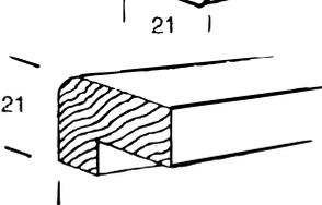
Unterleiste/Stützeleiste aus Buche mit eingefrästem U-Profil in der unteren Kante zum "Festhaken", um die Aushakmöglichkeit zu vermeiden. Obere Kante ausgefräst ca. 15 mm um Pinnwand oder Schreibtäfel zwischen Tragleiste und Unterleiste/Stützeleiste zu montieren.
